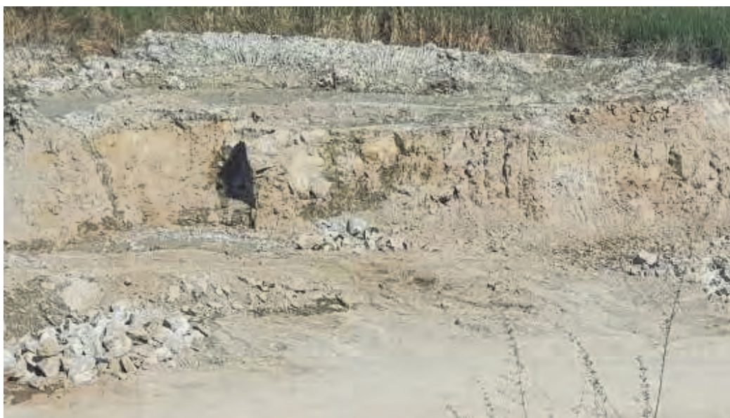
รูปที่ 12 ลักษณะชั้นเปลือกดินที่เกิดจากการผุพังอยู่กับที่ของหินแกรนิตในพื้นที่ประหานบัตร (พิกัดภาพถ่าย 1467800N/729076 E มุมมองไปทาง W)
