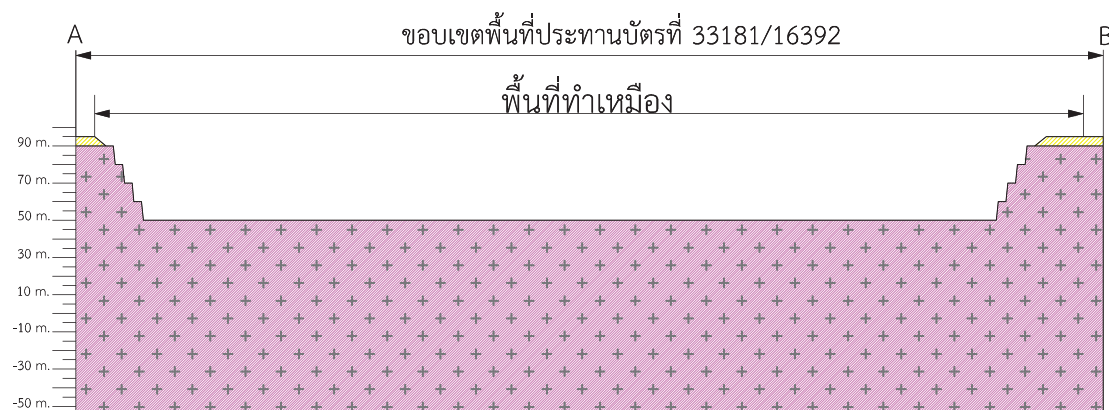
รูปที่ 21 แผนที่แสดงหน้าเหมืองและภาพตัดขวางบริเวณพื้นที่ประทานบัตรเมื่อสิ้นสุดการทำเหมืองปี พ.ศ. 2568
