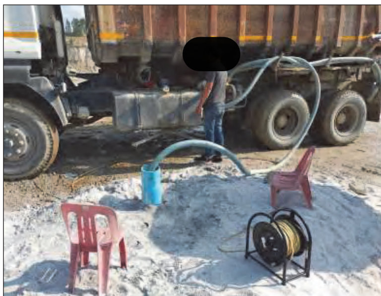
รูปที่ 6 แสดงการกรอกน้ำให้เต็มหลุมเจาะสำรวจเพื่อทดสอบหาการรั่วซึมของน้ำด้วยวิธี Slug Test
