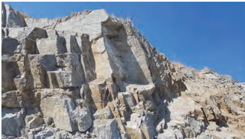
รูปที่ 15 แสดงรอยแตกที่พบในหินแกรนิตบริเวณพื้นที่ประทานบัตรโดยมี 2 แนวหลักคือ NW/15-35° S และ NE/60-70° N (พิกัดภาพถ่าย 1467516 N / 728918 E มุมมองไปทาง SW)
