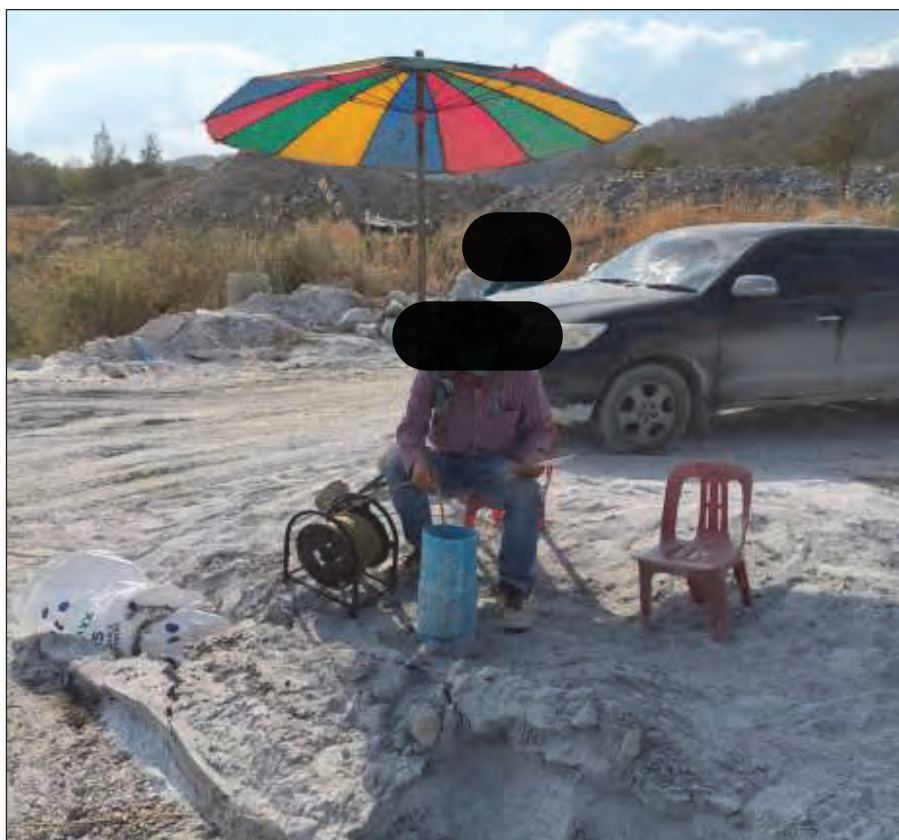
รูปที่ 7 การวัดระดับน้ำขณะทำการทดสอบหาความรั่วซึมของน้ำด้วยวิธี Slug Test
